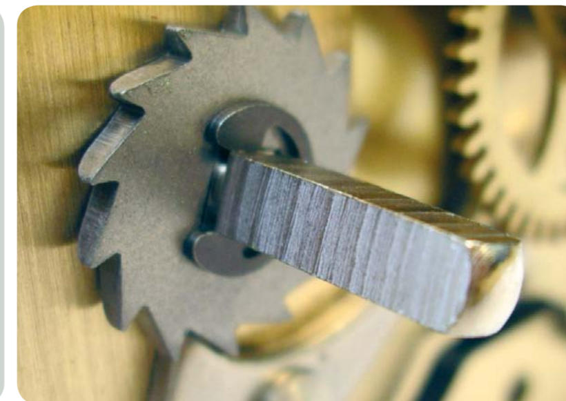
SPÄRRHJUL – Ratchet-wheel – Sperrad – Rochet. Foto: Hans Erman
